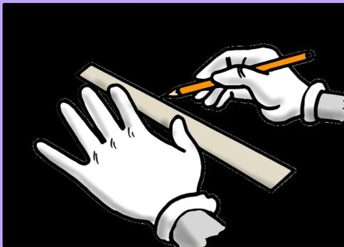
On appui avec la main sur la règle, pouce et index écartés, main à plat.
