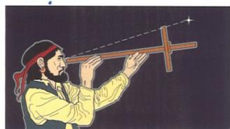
Pour se servir d'une arbalète, il fallait aligner la tige de bois sur l'horizon et faire glisser la pièce transversale pour viser l'étoile avec son extrémité. Il y avait plusieurs de ces pièces sur l'arbalète, ce qui permettait de mesurer des angles différents.
