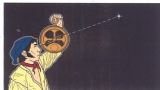
L'astrolabe n'ayant pas de fil à plomb, il était plus facile à utiliser à bord d'un navire que le quadrant.
