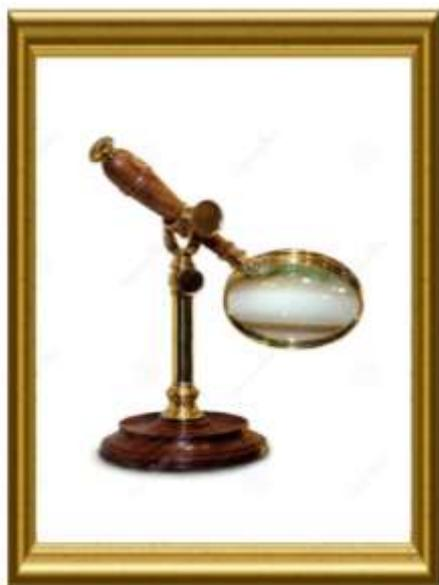
**Une loupe** est un instrument d'optique constitué d'une lentille convexe permettant d'obtenir d'un objet une image agrandie. La loupe est la forme la plus simple du microscope optique, qui, lui, est constitué de plusieurs lentilles.
