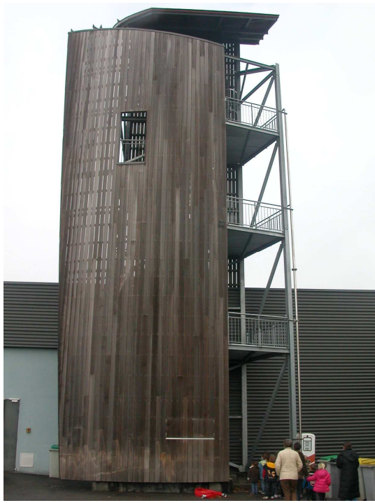
La tour de séchage sert à sécher les tuyaux et aux pompiers à s'entraîner.
