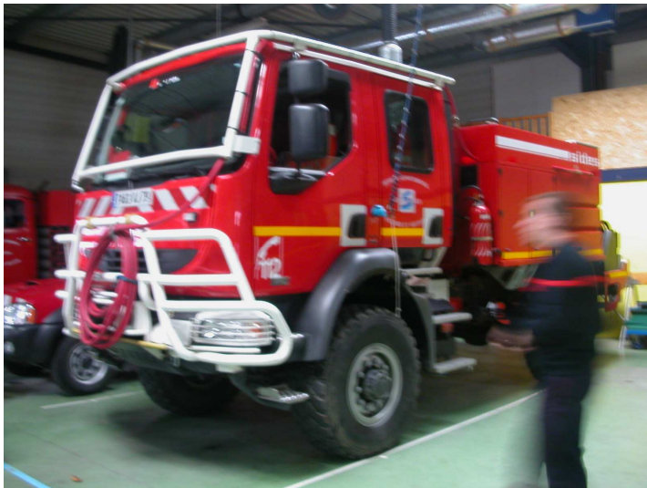
Le camion citerne pour éteindre les feux de forêt et de champs, avec les tuyaux et les lances à incendie.
