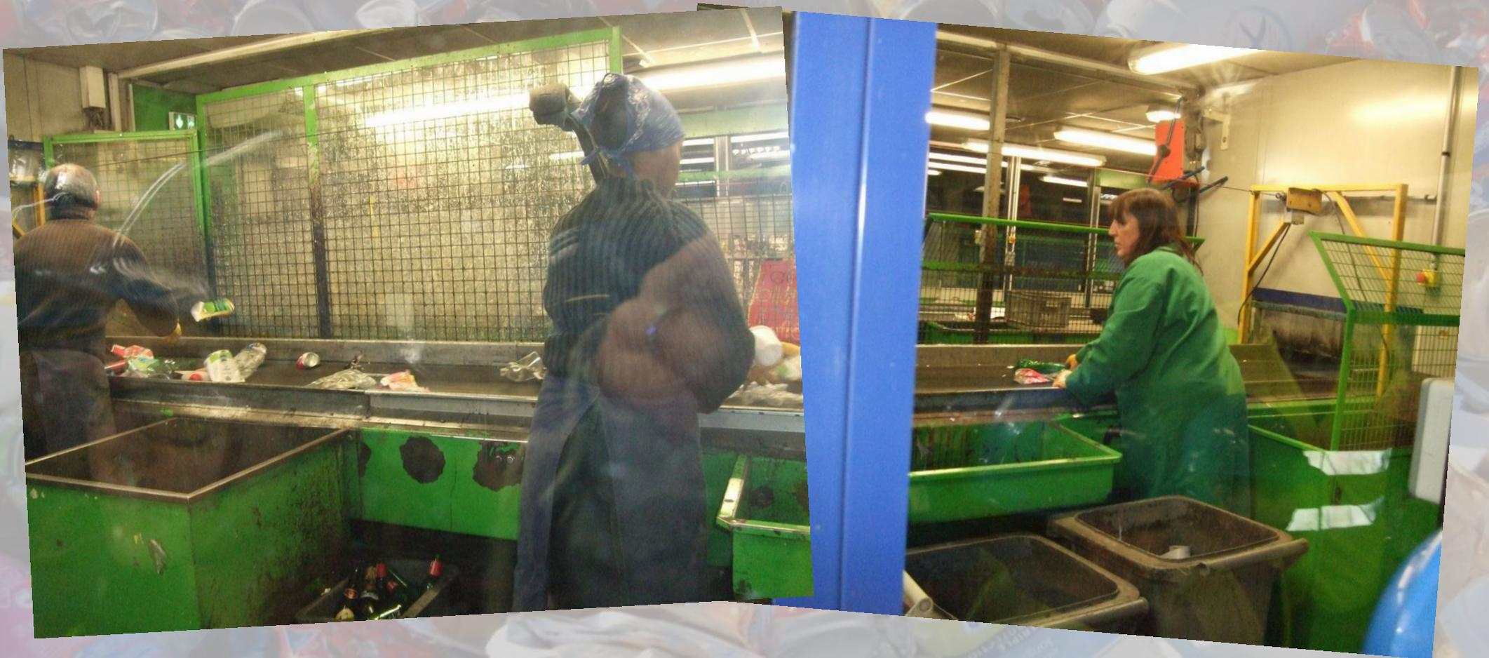
Ainsi sont séparés : papier, carton, brique alimentaire, plastique opaque ou transparent, aluminium et acier (« aspiré » par un aimant).
