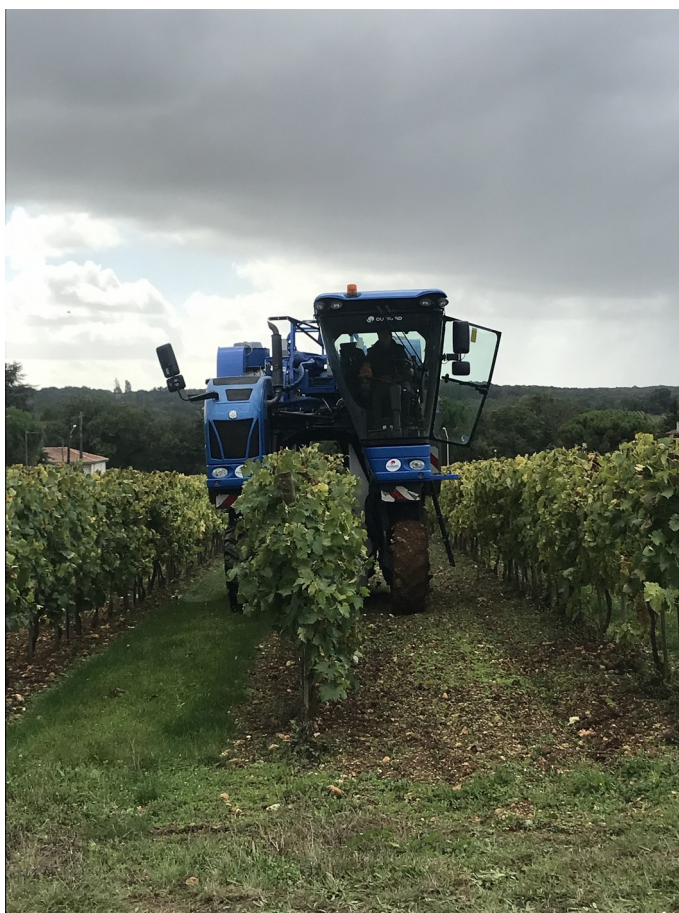
La machine à vendanger enjambe la vigne, la peigne et la secoue pour récupérer seulement les grains. Elle verse les raisins dans une remorque.
